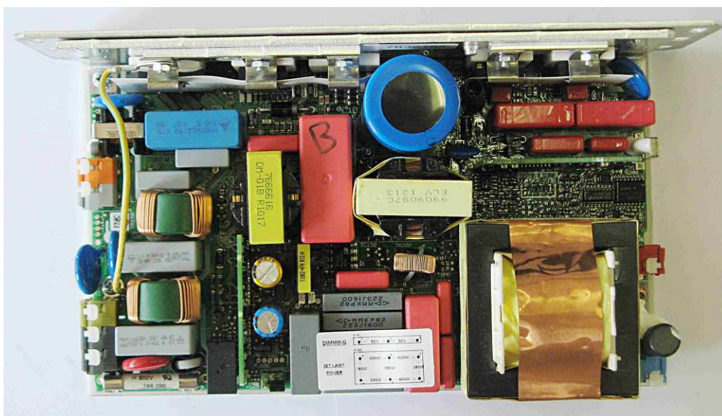
Obr. 25 Elektronický balast UV výbojky
